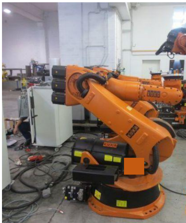
Figura 1: Braço mecânico kuka KR210 L150 KRC2 ED05
