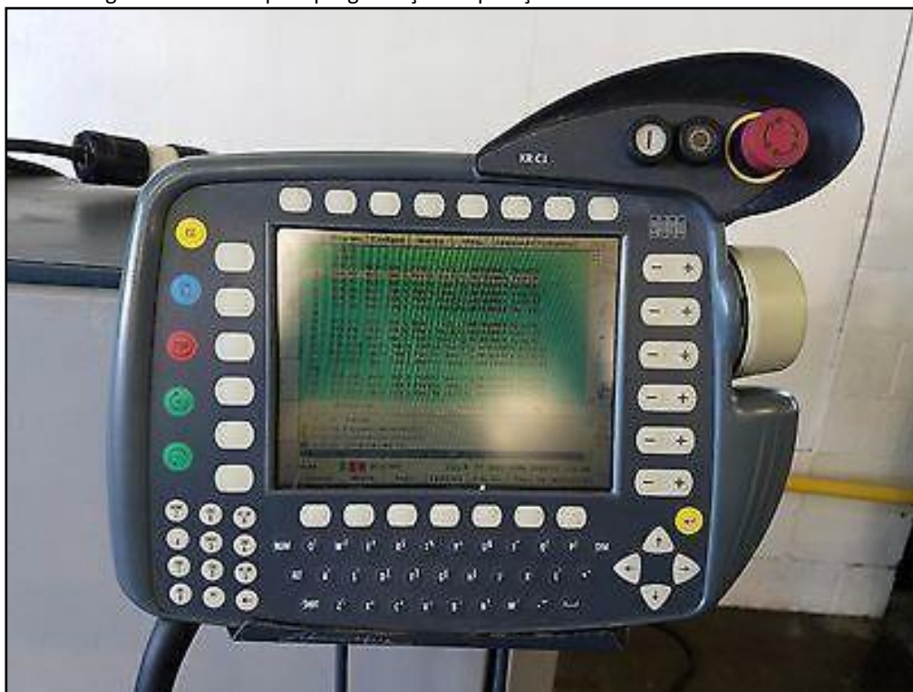
Figura 3: Controle para programação e operação kuka KR210 L150 KRC2 ED05
